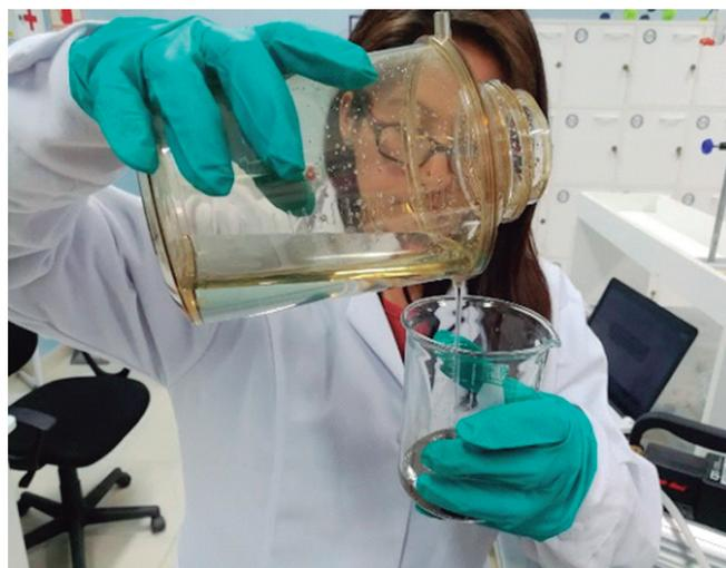
**Figura 2:** Vertido de NaCl (200mL) en la muestra de arena (50g)
